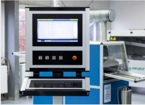
HMI-System mit kapazitiven Bedienelementen und Oberflächen aus Glas
