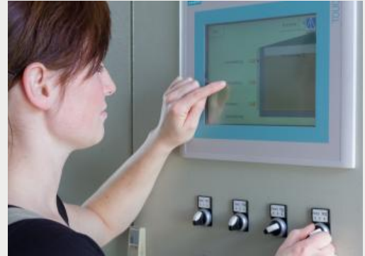
Integriertes Touchpanel in einer Bedienfront. Das Touchpanel besitzt ein Kunststoffgehäuse, ein Folienoverlay und ein Display mit resistivem Touchscreen.
